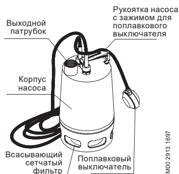
Рис. 1 Конструкция насосов UNILIFT AP
