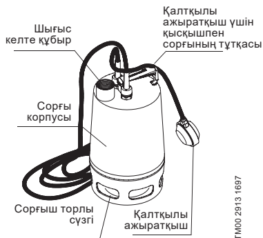
1-сур. UNILIFT AP сорғыларының конструкциясы
