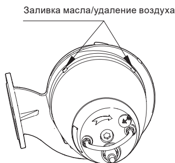
Рис. 22 Отверстия для заливки масла
